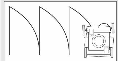
**FR** - Si l'unité se déplace toujours dans la même zone de la piscine sans couvrir d'autres zones, modifier l'installation de l'essieu en réglant la configuration de verrouillage de l'essieu (a). Cela permettra au nettoyeur de se déplacer en suivant une nouvelle configuration.
